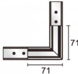
Соединитель углового шинпровода для завершения. Используйте вместе с угловым соединением Powergear.
