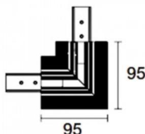
Соединитель углового шинопровода для завершения. Используйте вместе с угловым соединением Powergear.
