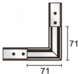
Соединитель углового шинопровода для завершения. Используйте вместе с угловым соединением Powergear.
