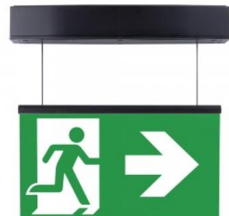
Благодаря специальной линзе освещает на расстояние до 30 метров. Дополнительные аксессуары включают: Комплект для врезки, набор для настенного крепления, набор для подвеса и стекло с указателями направления. Тестирование может быть выполнено либо вручную с помощью кнопки на светильнике, либо с использованием системы централизованного мониторинга WELLS (беспроводная центральная система мониторинга).
