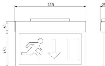
Батарея длится 3 часа. Время зарядки 24 ч Светильник является двусторонним. Он поставляется с наклейками (вправо, влево) Два режима работы: загорается, когда электричество прерывается или постоянно. Регулируемый переключатель. Изготовлено ЕС.
