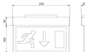
Батарея длится 3 часа. Время зарядки 24 ч Светильник является двусторонним. Он поставляется с наклейками (вправо, влево) Два режима работы: загорается, когда электричество прерывается или постоянно. Регулируемый переключатель. Изготовлено ЕС.
