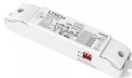
Диммируемый блок питания для светодиодов DALI, который легко перенастраивается. 0,9-12 Вт 100 mA / 9-42 В / 0,9-4,2 Вт 150 mA / 9-42 В / 1,35-6,3 Вт 200 mA / 9-42 В / 1,8-8,4 Вт 250 mA / 9-42 В / 2,25-10,5 Вт 300 mA / 9-40 В / 2,7-12 Вт 350 mA / 9-34 В / 3,15-11,9 Вт 400 mA / 9-30 В / 3,6-12 Вт
