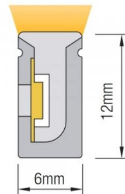
Светодиодная лента Neon Flex, где светодиоды находятся в специальном материале, который равномерно рассеивает свет. Светодиодные ленты Neon Flex гибкие и легко устанавливаются. Интервал резки светодиодной ленты составляет 50 мм. Светодиодная лента класса защиты IP65-67 подходит для использования как в помещении, так и на улице. Можете быть уверены в наших продуктах, так как мы продаем сотни метров светодиодных лент каждый день! Отправьте нам запрос, и мы сделаем вам предложение!
