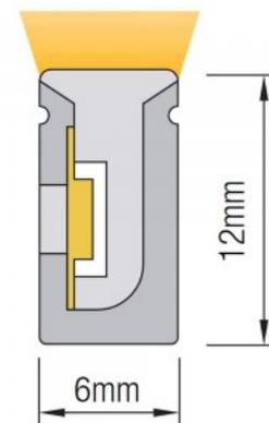
Светодиодная лента Neon Flex, где светодиоды находятся в специальном материале, который равномерно рассеивает свет.
